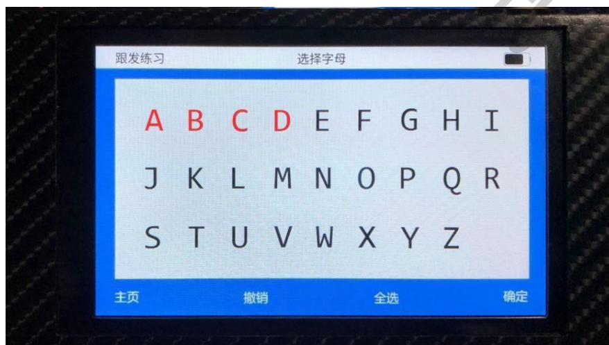
进入跟发练习主页面以后，点击左下角开始按钮，系统会随机生成练习组。按照生成的练习组逐个播报跟发学习的电码，播报速度按照设定速度进行。练习者根据播报的点划节奏进行输入练习。输入正确则按照顺序进行播报和练习。如输入的电码非播报的电码，则系统重新播报该电码，直到正确后才会正常顺序练习。
