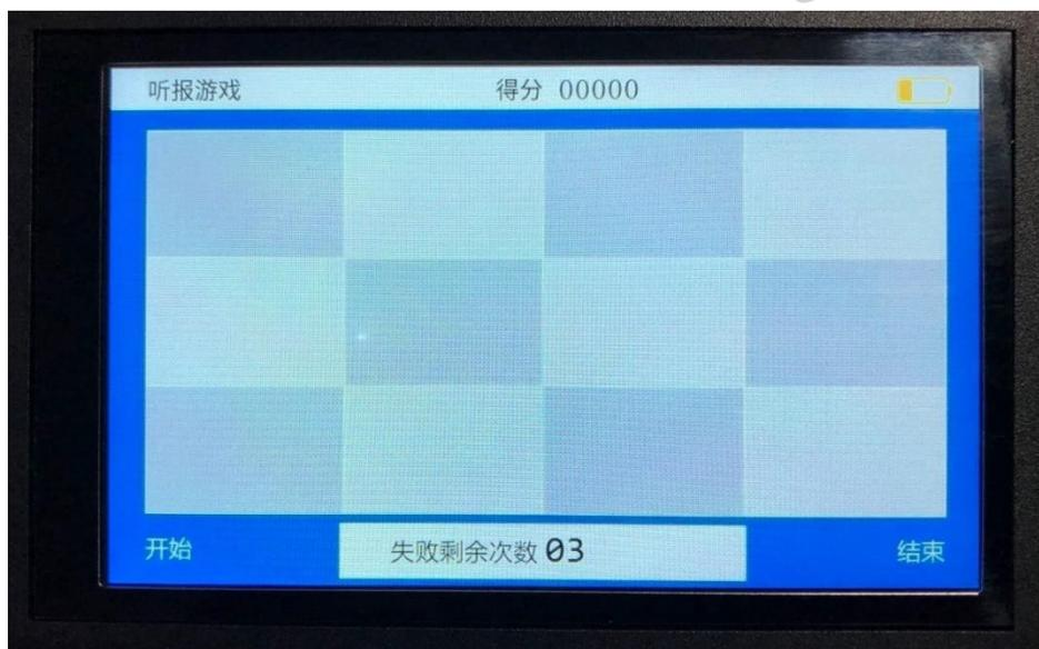
点击开始后，练习器开始播报电码，点击听到的正确电码，如选择正确，上栏得分加分；如选择错误，下栏失败剩余次数减 1。无论正确还是错误，机器都会继续播报电码，供使用者点击选择。
