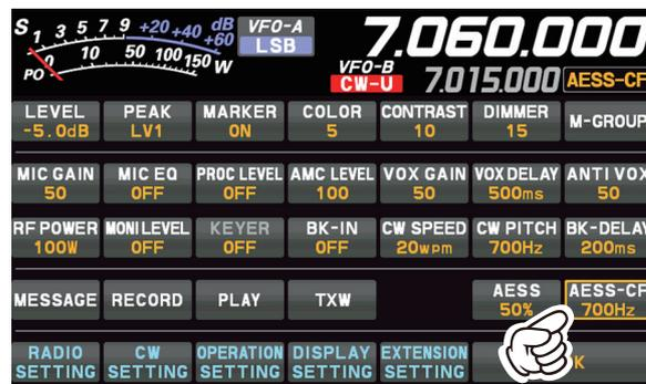
3. 转动 [FUNC]旋钮，从“700Hz”和“1000Hz”中选择截止频率。通常，700Hz是一种平衡的音质，但以大音量收听时，请将其设为1000Hz。
