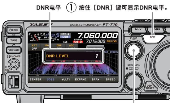
DNR电平 ① 按住 [DNR] 键可显示DNR电平。
