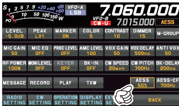
3. 转动 [FUNC]旋钮，根据您的喜好调整两个扬声器的输出平衡。建议在50%左右使用。
