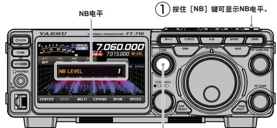
① 按住 [NB] 键可显示NB电平。
