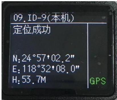
(3)本机获取其他成员信息/测距: 在 GPS 主界面下通过[▲]/[▼]键选择所查找的成员 ID 号 (ID-1.....ID-20),按 PTT1 发射 (主频率要一致)再松开对方位置信息就能回传,按“MENU”键切换如下图,图 2 所示对方方位和本机距离。
