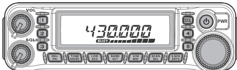
**FT-7900R** 是一款精工打造的高品质双频段调频电台，可提供功率为 50 瓦的 144 MHz 业余波段和功率为 45 瓦的 430 MHz 业余频段。
