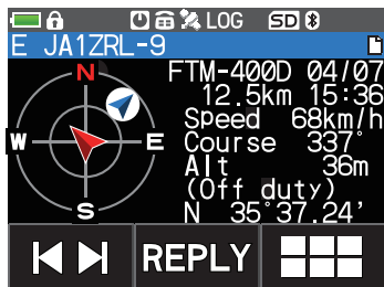
接收到APRS信号时的显示示例
