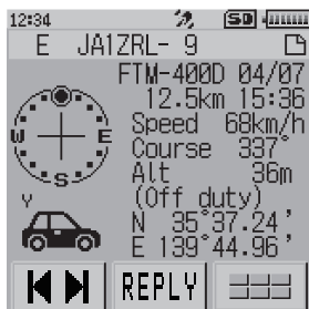
接收到APRS信号时的 显示示例
