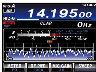
3. 按住 **TUNE** 按钮 1 秒可开始自动调谐。发射器将启用，且调谐过程中“**TUNER**”图标将闪烁。达到最佳调谐点时，电台将返回接收状态，且“**TUNER**”图标将再次保持稳定点亮状态（不再闪烁）。
