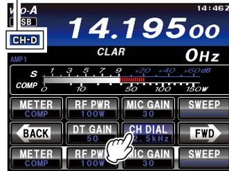
2. 触按 **[CH DIAL]** 以选择所需的频率步进。触按 **[CH DIAL]** 可按如下切换频率。
