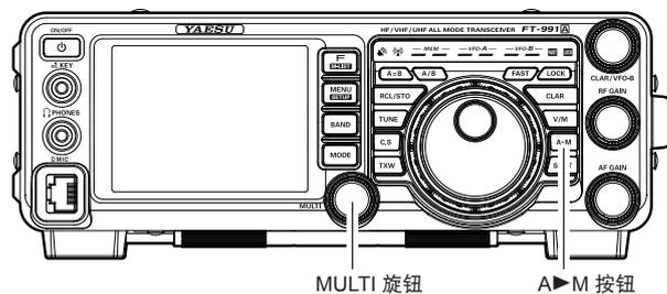
2. 转动 **MULTI** 旋钮可选择其他存储信道。要退出存储信道检查模式，再次短按 **A▶M** 按钮。
