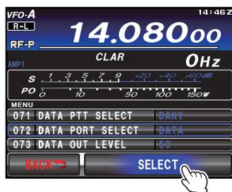
4. 转动 **MULTI** 旋钮可选择菜单项 “060 PC KEYING”。触按 LCD 上的 [**SELECT**], 然后转动 **MULTI** 旋钮可将此菜单项设置为 “RTS” 或 “DTR”。按下 **MENU (SETUP)** 按钮或触按 LCD 上的 [**BACK**], 可返回到正常操作模式。
