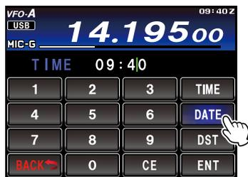
5. 使用 LCD 上的数字键输入月、日和年，然后触按 **[ENT]**。
