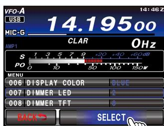
4. 触按 LCD 上的 [**ENTER**]，然后触按 LCD 上的 [**BACK**] 或按下 **MENU** 按钮可保存新设置并返回到正常操作模式。
