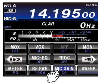
**在 AM 模式下**，触按 [**MIC GAIN**]，然后调节 **MULTI** 旋钮，使 ALC 表在音量高峰时不偏转。
