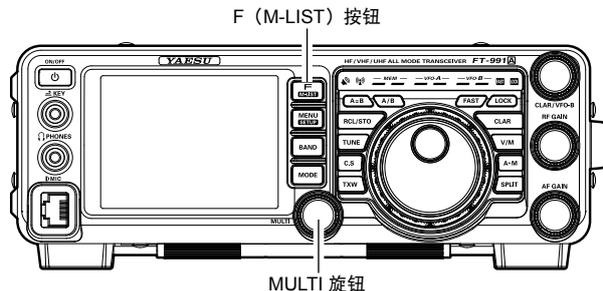
请参考图“B”，显示了轮廓消噪滤波器通带中心的“凹陷”。轮廓消噪滤波器根据菜单项“114 CONTOUR LEVEL”和“115 CONTOUR WIDTH”的设置，将低 Q 值“陷波”置于通带中。逆时针转动 **MULTI** 旋钮可使陷波在通带内向较低频率移动，顺时针转动可使陷波在通带内向较高频率移动。通过移除接收信号的干扰或不需要的频率分量，可以从背景噪音 / 干扰中提升所需信号，并显著提高清晰度。
