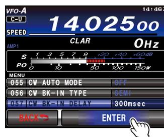
6. 按下 **MENU (SETUP)** 按钮或触按 LCD 上的 **[BACK]**，可返回到正常操作模式。
