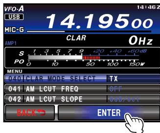
5. 按下 **MENU (SETUP)** 按钮或触按 LCD 上的 **[BACK]**,可返回到正常操作模式。
