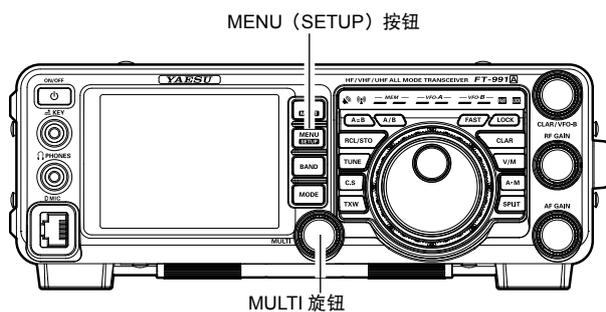
4. 调节或设置完成后，触按 LCD 上的 [**ENTER**] 可保存新设置，然后按下 **MENU (SETUP)** 按钮或触按 LCD 上的 [**BACK**]，可返回到正常操作模式。
