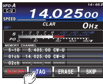
4. 触按 LCD 上的键可输入所需标签的字母、数字或符号。
