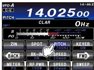
2. 转动 **MULTI** 旋钮可调节音调（300 Hz 至 1050 Hz）。
