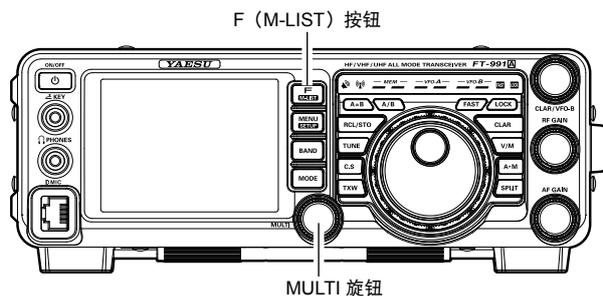
3. 发射过程中，转动 **MULTI** 旋钮可调节耳机或扬声器中的语音音量。顺时针转动该旋钮可提高音量。
