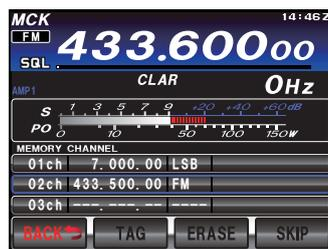
7. 要登录发射频率，按住麦克风上的 **PTT** 按钮，并同时按住 **A▶M** 按钮。长按 **A▶M** 按键后，发出 2 声提示音说明数据已经存储到所选信道中。存储保存完毕后，画面上将显示接收频率。
