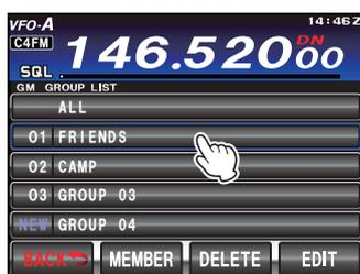
7. 触按 LCD 上的 **[BACK]** 两次。将关闭 GM 功能，并且显示屏将返回上一画面。
