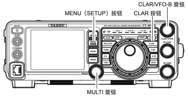
7. 转动 **CLAR/VFO-B** 旋钮,可设置所需发射器频率偏移值。最大可设置为  $\pm 9.999$  kHz。
