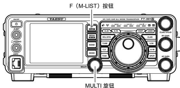
3. 转动 **MULTI** 旋钮以在 15 种算法中选择可将噪音电平降至最低的一种算法。
