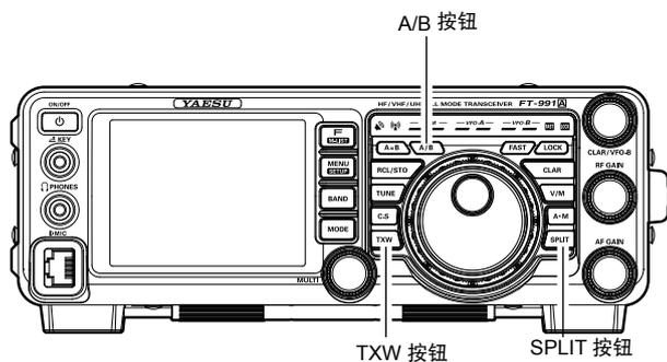
异频操作中，VFO-A 寄存器将用于接收，而 VFO-B 寄存器将用于发射。如果再次按下 **SPLIT**，异频操作将被取消。
