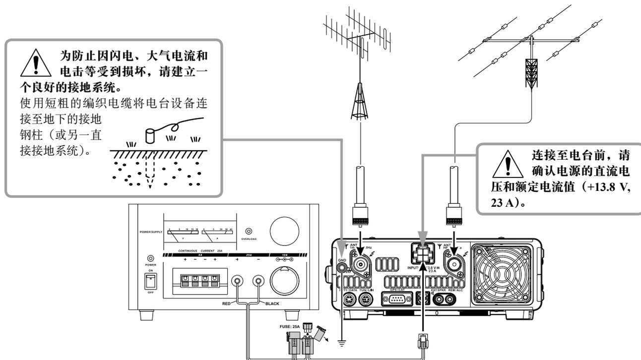
我们建议使用 **FP-1030A**（仅美国市场）交流电源。其他型号的电源也可用于 **FT-991A**，但必须严格遵守上述规定的直流电缆极性，13.8 VDC 输入电压和 23 A 的电流。
