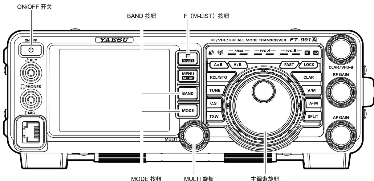
1. 按下 **BAND** 按钮可显示频段列表，然后触按与想要操作的业余频段相应的频段按键。再次按下 **BAND** 按钮，可关闭频段列表画面。
