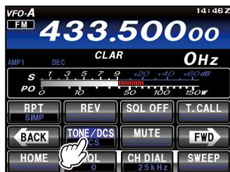
5. 触按 [**FWD**] 切换画面，然后触按 [**DCS**]。转动 **MULTI** 旋钮选择所需的 DCS 编码。总共提供 104 组标准 DCS 编码（请参见 DCS 编码表）。
