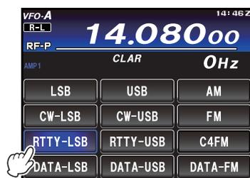
3. 按下 **MENU (SETUP)** 按钮。显示屏上将显示菜单列表。转动 **MULTI** 旋钮可选择菜单项 “072 DATA PORT SELECT”。触按 LCD 上的 [**SELECT**], 然后转动 **MULTI** 旋钮可将此菜单项设置为 “USB”。触按 LCD 上的 [**ENTER**]。
