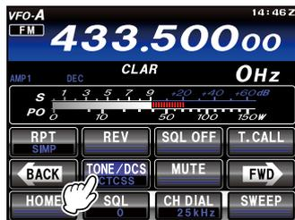
5. 触按 [**FWD**] 可切换画面，然后触按 [**TONE**]。转动 **MULTI** 旋钮可选择需要使用的 CTCSS 音频。总共提供 50 个标准 CTCSS 音频（请参考 CTCSS 音频表）。
