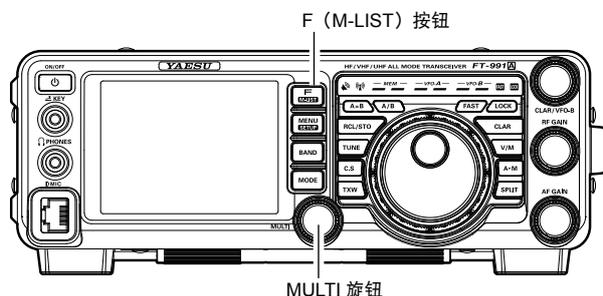
3. 按下 **F (M-LIST)** 按钮，然后触按 [PROC] 可显示压缩电平（从 1 至 100），确认参数化麦克风均衡器已启用。
