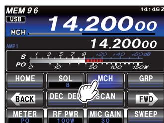
5. 转动 **MULTI** 旋钮可在所选存储组中选择所需的存储信道。
