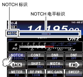
3. 转动 **MULTI** 旋钮可调节陷波滤波器的“无效”位置。
