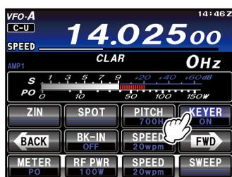
4. 触按 LCD 上的 **[SPEED]**，然后转动 **MULTI** 旋钮可设置所需发射速度（4 - 60 WPM）。
