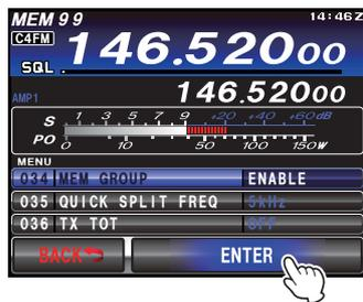
5. 按下 **MENU (SETUP)** 按钮或触按 LCD 上的 [**BACK**] 可退出。操作将限制为 6 个存储组。
