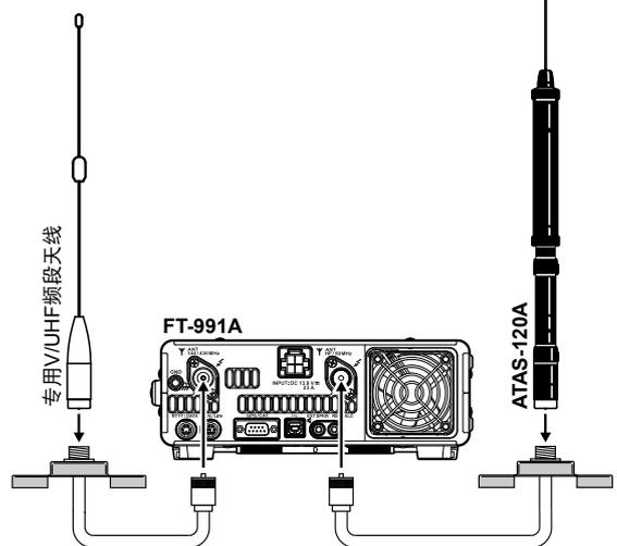
使用双工电线时，**ATAS-120A** 的 ANT 端子和 **FT-991A** 的 HF/50MHz ANT 端子必须串行连接并与接地绝缘，以供应 **ATAS-120A** 的控制电压。
