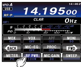
5. 调节麦克风放大器增益使麦克风与您的音量相匹配：反复触按 LCD 上的 [**METER**] 以选择“ALC”。按住 **PTT** 键，以正常音量对麦克风讲话。**在 SSB 模式下**，触按 [**MIC GAIN**]，然后调节 **MULTI** 旋钮，使 ALC 表在音量高峰时保持在仪表的 ALC 范围内（最多偏转一半）。
