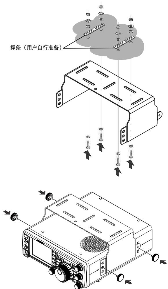
通过改变前安装螺钉的位置，可调整电台的视角。
