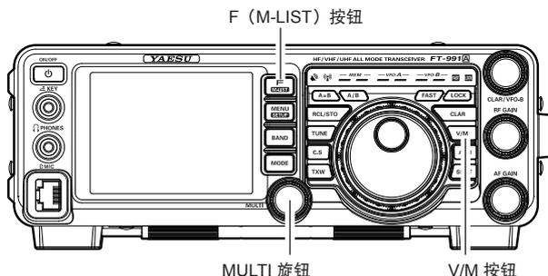
3. 触按 LCD 上的 [MCH]，然后转动 **MULTI** 旋钮可选择所需存储信道。
