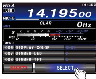
4. 触按 LCD 上的 [**ENTER**]，然后触按 LCD 上的 [**BACK**] 或按下 **MENU** 按钮可保存新设置并返回到正常操作模式。
