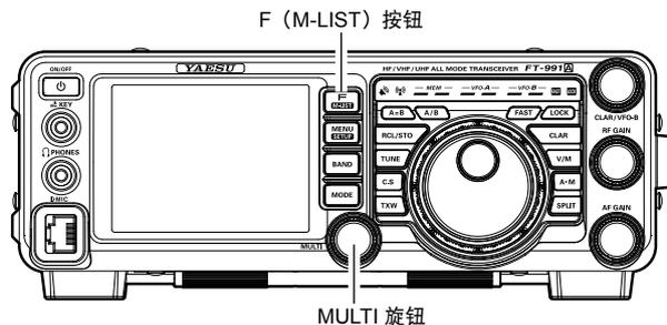
3. 转动 **MULTI** 旋钮可将音量设置到适中位置。
