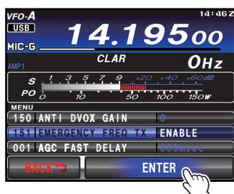
5. 按下 **MENU (SETUP)** 按钮或触按 LCD 上的 [**BACK**], 可返回到正常操作模式。现在可以在此标定频率上进行紧急报警通信。
