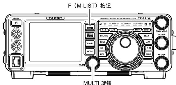
4. 开始发射，转动 **MULTI** 旋钮可调节延迟时间，将其设为令您感觉操作舒适的时间。
