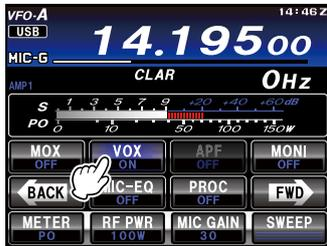
2. 无需按 PTT 键，用正常音量对着麦克风讲话。讲话时，发射器将自动启用。讲完后，电台将返回到接收模式（稍有延迟）。
