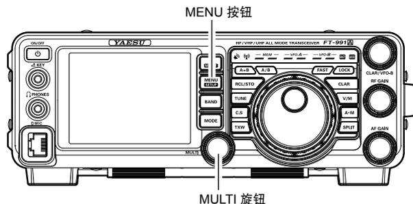
4. 转动 **MULTI** 旋钮可按需求调节接收器音频响应。
