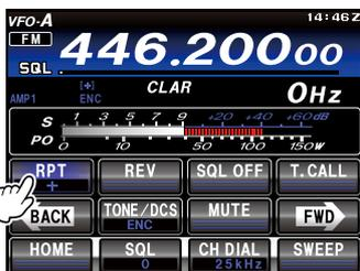
5. 触按 **[FWD]** 可切换显示画面，然后触按 **[TONE]**。转动 **MULTI** 旋钮可选择需要使用的 CTCSS 音频。总共提供 50 组标准 CTCSS 音频（请参考 CTCSS 音频表）。
