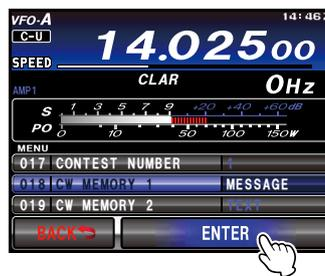
5. 按下 **MENU (SETUP)** 按钮或触按 LCD 上的 [**BACK**]，可返回到正常操作模式。
